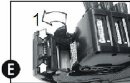
Drücken Sie die geriffelten Schenkel die sich am Farbwalzenhalter befinden zusammen und ziehen diese hoch. Tauschen Sie die Farbwalze aus und legen Sie diese wieder ein (einrasten). Verschieben Sie die den Walzenhalter.
