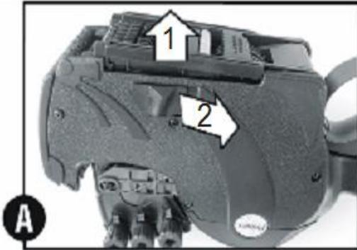
Legen Sie die neue Etikettenrolle mit der Etikettenrückseite nach oben ein. Ziehen Sie den Etikettenstreifen ca. 15 cm aus dem Etikettierer. Schließen Sie die Bodenplatte (1) bis sie einrastet. Entfernen Sie bitte die Etiketten auf dem Etikettenstreifen.
