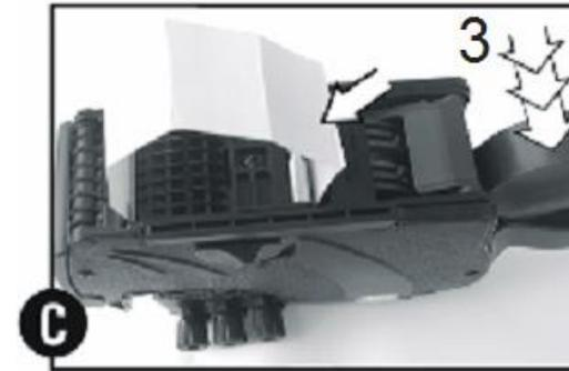
Sollte die automatische Ausrichtung fehlschlagen, lösen Sie bitte mit Hilfe eines Schraubenziehers die Kreuzschraube (Justierung der Gleitplatte). Nach erfolgter Justierung ziehen Sie die Kreuzschraube wieder fest.
